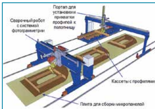
Рисунок 2 – Роботизированный комплекс сборки и сварки микропанелей
