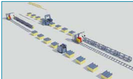
Рисунок 4 – Комплекс для изготовления тавровых балок
