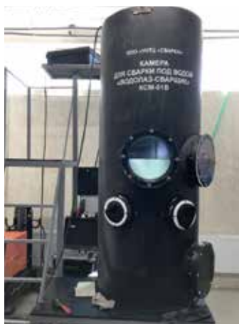
Гидрокамера для мокрой подводной сварки, и установка для определения диффузионного водорода
