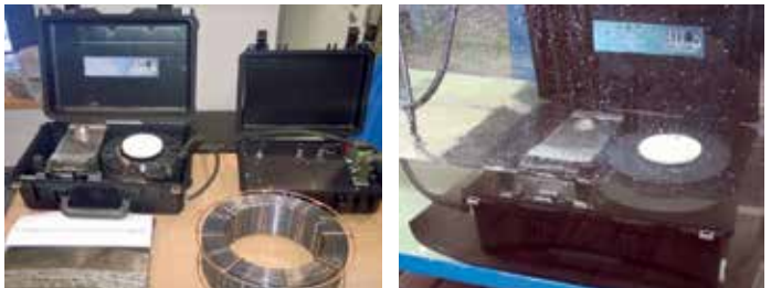
Вид комплекса «КОПС-М» для мокрой подводной сварки и резки порошковой проволокой по ТУ 441-001-83763787-2016: герметичный погружной механизм подачи порошковой проволоки, корабельный блок управления режимом сварки, сварочная горелка; электрические кабели, порошковая проволока
