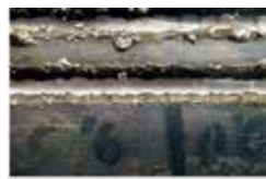
Рис.5- Внешний вид лицевой и обратной поверхности пластин толщиной 8 мм, разрезанных в камере стенда с помощью КОПС-М порошковой проволокой ППС-АПС.
