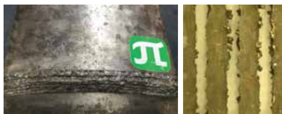
Вид сварного соединения из трубной стали К60 толщиной 21,3 мм после мокрой подводной сварки порошковой проволокой ПС-АПЛ2 на глубине 14 м. Справа - стальные пластины толщиной 8 мм после подводной резки проволокой ППР-АПЛ1 диаметром 2 мм
