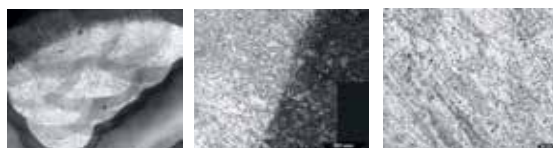
Макроструктура и микроструктура сварного соединения из трубной стали К60 толщиной 21,3 мм после мокрой подводной сварки порошковой проволокой ПС-АПЛ2
