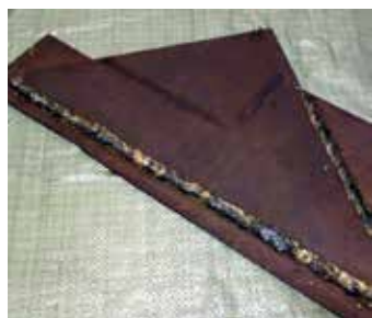
Рис.4- Образец, сваренный в камере стенда с помощью КОПС-М порошковой проволокой ППС-АПЛ 2.
