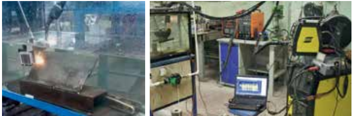
Испытание порошковых проволок для подводной сварки в лаборатории
